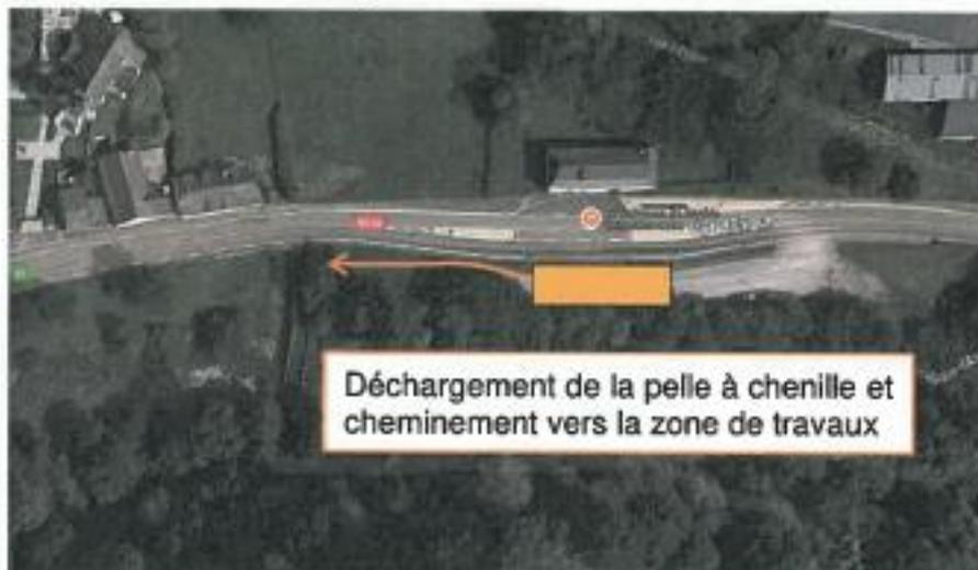
Lors de cette opération, l'entreprise utilisera une pelle à chenille 25 à 30T équipée d'un BRH et d'une cisaille béton afin de démolir et réduire les éléments béton.
